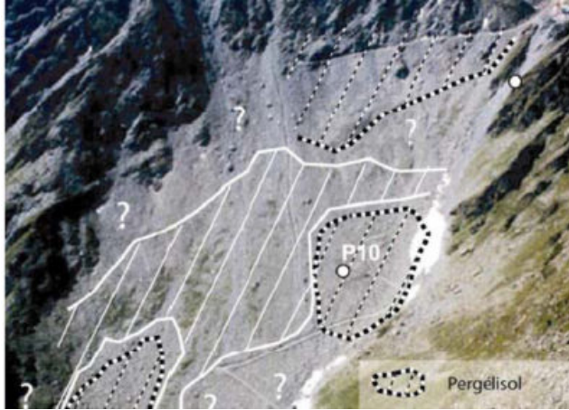
Fig. 4 – Distribution supposée du pergélisol dans un éboulis
