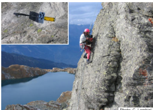
Fig. 4 – Capteurs de température dans une paroi rocheuse
