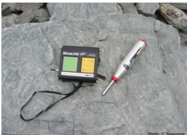
Fig. 1 – Le marteau de Schmidt, un outil pour mesurer les degrés d’altération de blocs de surface.
