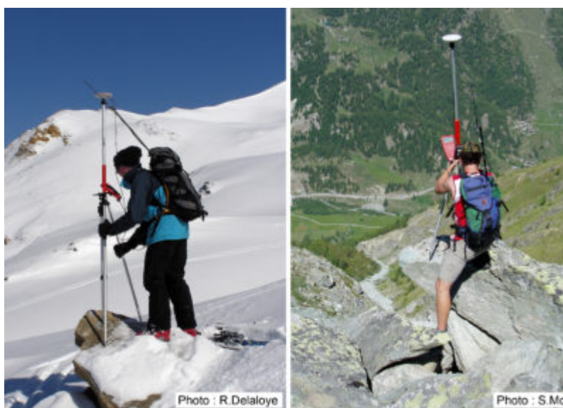
Fig. 1 – Suivi par GPS des mouvements de glaciers rocheux (à gauche : Becs-de-Bosson (Réchy, VS) ; à droite : Tsarmine (Val d’Arolla, VS).
