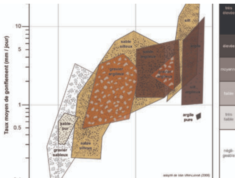
Fig. 2 – Gélivité et taux de gonflement moyen d'un sol meuble selon sa composition granulométrique (adapté de Val Vliet-Lanoë 2005).
