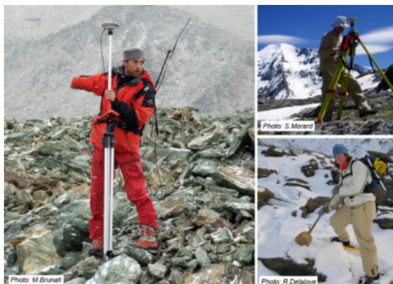
Fig. 5 – Mesures du déplacement de terrain par GPS différentiel... demandant parfois quelques talents d'équilibriste et de balayeur !
