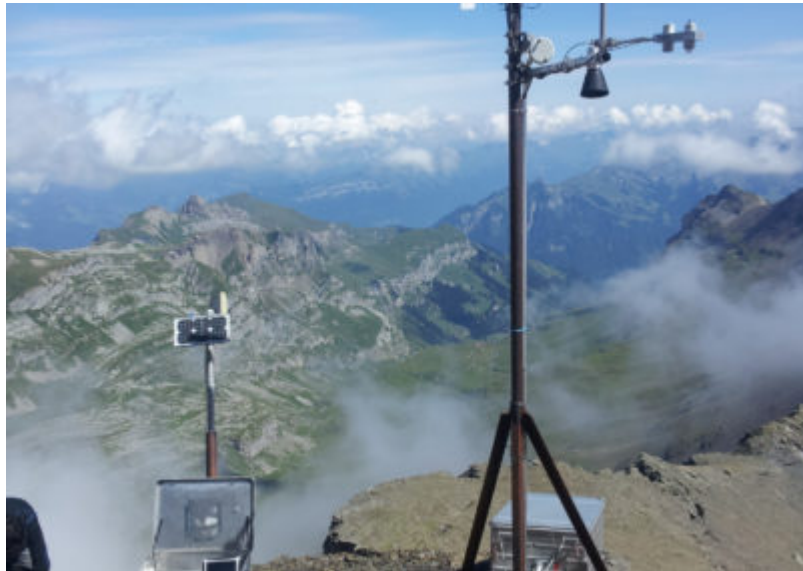
Fig. 3 – Station PERMOS située sur la crête rocheuse du Schilthorn couverte d'une faible couche de débris. Le permafrost du Schilthorn est pauvre en glace.
