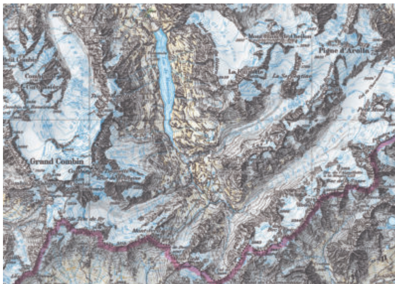
Fig. 3 – Le barrage de Mauvoisin draine un bassin versant de 167 km 2 , dont le 44 % est occupé par des glaciers (source : swisstopo).
