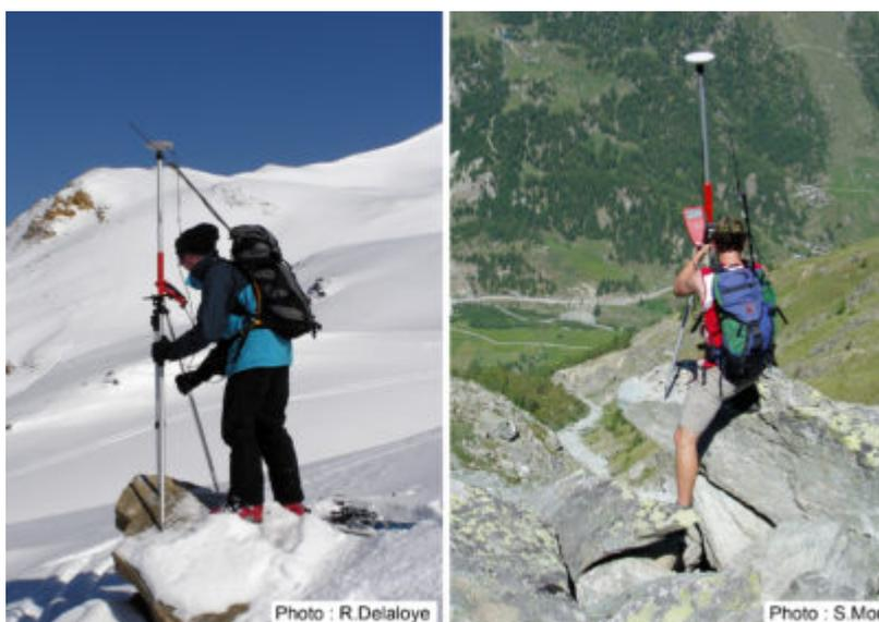
**Fig. 1 – Suivi par GPS des mouvements de glaciers rocheux (à gauche : Becs-de-Bosson (Réchy, VS) ; à droite : Tsarmine (Val d'Arolla, VS).**
