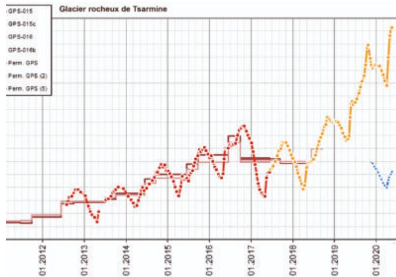
**Fig. 12 – Vitesse de déplacement de la surface du glacier rocheux de Tsarmine calculée par un GPS permanent installé à l'amont du front (la station a été déplacée en 2016 pour éviter qu'elle ne bascule dans le couloir situé à l'aval du glacier rocheux) (source : [UniFR](#)).**
