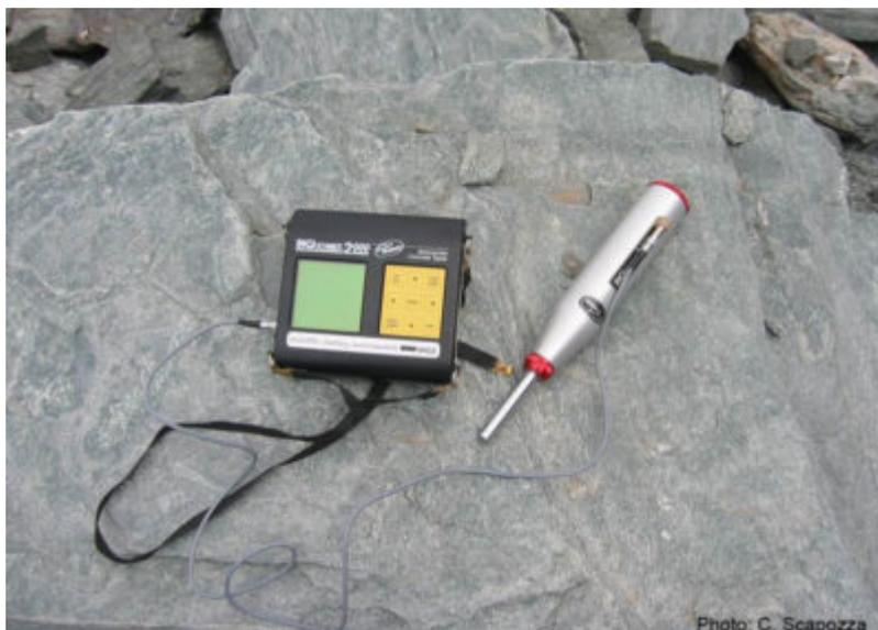
**Fig. 1 – Le marteau de Schmidt, un outil pour mesurer les degrés d'altération de blocs de surface.**
